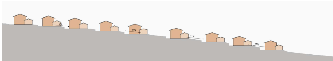
Systemschnitt West-Ost mit Darstellung der maximalen Baukörpertiefen und Auf- und Abtragshöhen
